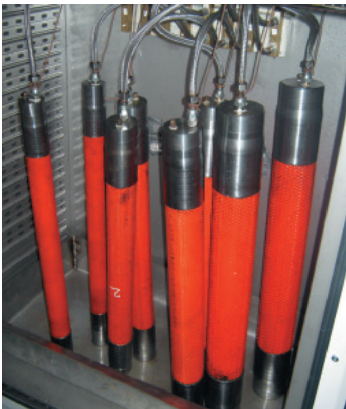
Рис. 2. Образцы труб ИЗОПРОФЛЕКС в термошкафу
