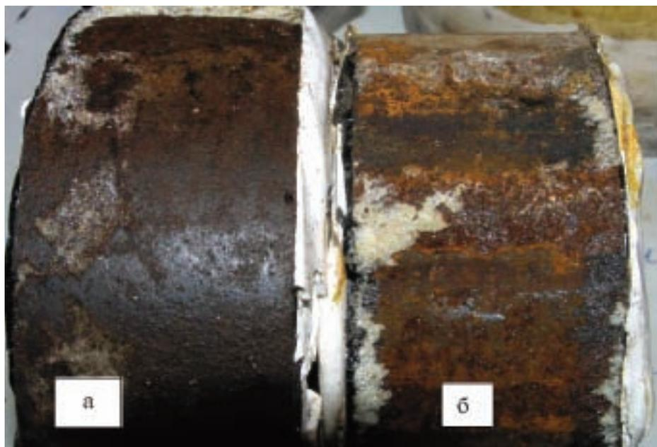
Поверхность стальной трубы после проведения испытаний на склонность к коррозии под действием блуждающих токов и удаления ППМИ: при увеличении  $\times 50$
