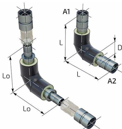
Отвод 90гр ПОЛИМЕРТЕПЛО.PRO применяется для изменения направления потока жидкости в трубопроводе на угол 90°; изготавливается без изменения внутреннего сечения (т.е.  $A1=A2$ ). Используется преимущественно в тех случаях, когда собственной гибкости трубы не достаточно для осуществления поворота теплотрассы — например, в стесненных условиях, при прокладке трубопровода в каналах.
